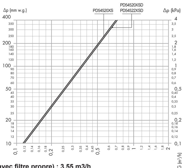
Version coudée Kv (avec filtre propre) : 3,55 m<sup>3</sup>/h
