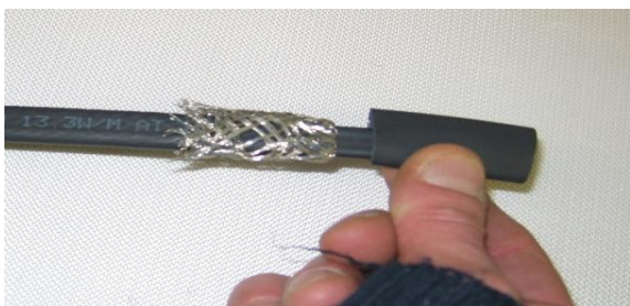
5) Insérer le manchon caoutchouc (50mm) jusqu'à la tresse
