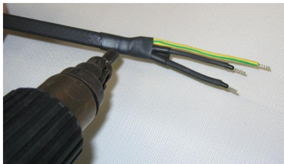
17) Chauffer pour rétracter
