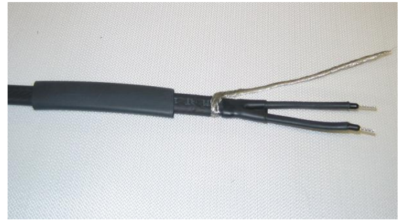
14) Insérer le manchon caoutchouc (45mm) sur l'ensemble
