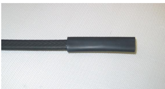
10) Insérer le manchon caoutchouc (70mm) sur l'extrémité du cable chauffant en laissant dépasser d'environ 15mm
