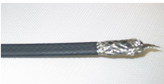
9) Rabattre la tresse métallique et torsader l'extrémité
