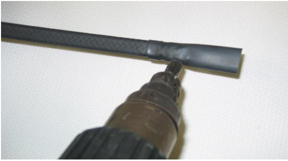
11) Chauffer le manchon
