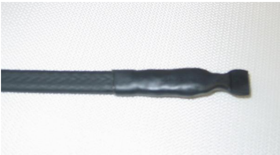
13) Réaliser un test de résistance d'isolement du cable chauffant (RI > 10 M Ohm)
